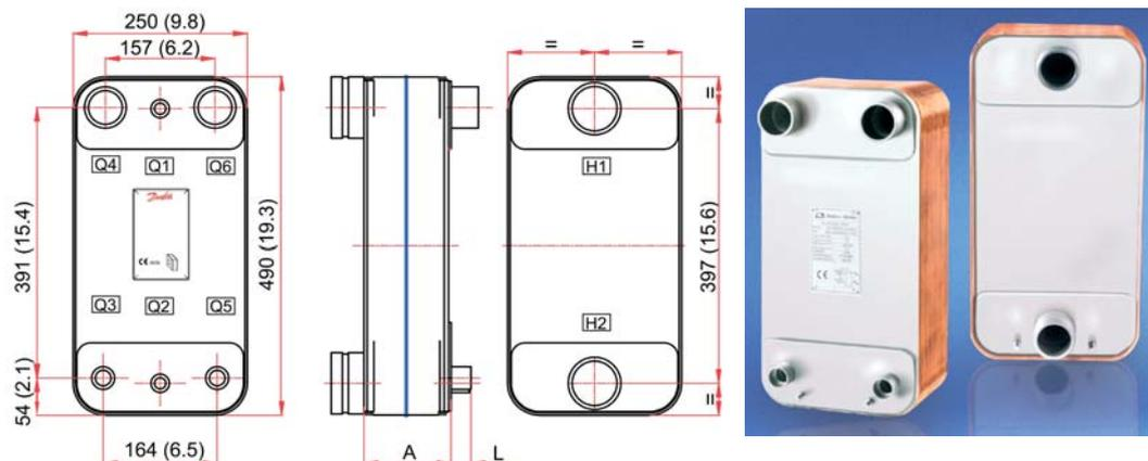
Габаритные размеры и изображение теплообменника пластинчатого паяного модификации В-113
